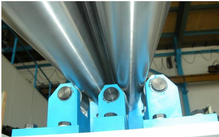
⇒ die Oberwalze ist rechts mit Schwenklager gelagert
